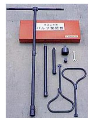
T字型のバルブ開閉器(左)の 先にアダプタ(右の棒状のもの) を装着
